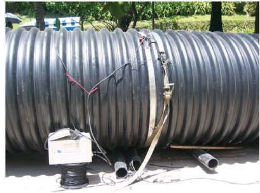
เชื่อมต่อภายนอกด้วยแผ่นพื่อเชื่อมด้วยไฟฟ้า ไม่มีการรั่วซึม
